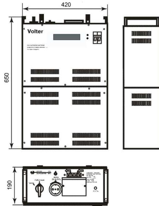
Стабилизатор СНПТО-27 выполнен в корпусе с жидкокристаллической индикацией.
