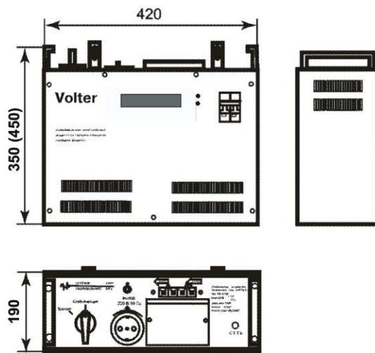
Стабилизатор СНПТО-14 выполнен в корпусе с жидкокристаллической индикацией.
