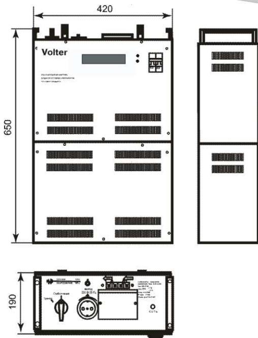
Стабилизатор СНПТО-22 выполнен в корпусе с жидкокристаллической индикацией.
