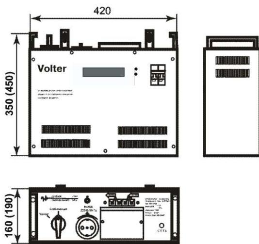
Стабилизатор СНПТО-9 выполнен в корпусе с жидкокристаллической индикацией.
